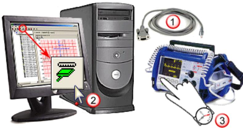
1. 除細動器を RescueNet Code Review ワークステーションのシリアルポートに接続します。M Series/E Series には、弊社の RS-232 Data Transfer Cable (データ転送ケーブル) (弊社部品番号: 8000-0605-01) を必ず使用してください。このケーブルの終点は、DB9 メスコネクターです。1600/1700 には、弊社 1600 Serial Link Cable and Connector (シリアルリンクケーブル及びコネクター) (弊社部品番号 8000-1614) を必ず使用してください。
