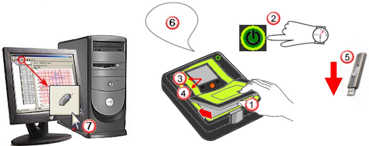
1. Retirez le couvercle du compartiment de la pile sur le dessus d'AED Pro. Dégagez le loquet avant et soulevez le couvercle pour le retirer.
