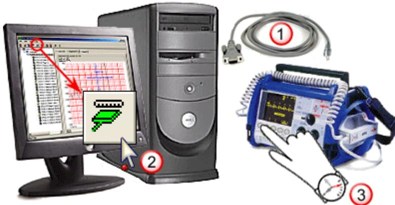
1. Branchez le défibrillateur au port série du poste de travail RescueNet Code Review. Pour les modèles de la série M ou E, utilisez le câble de transfert des données ZOLL RS-232 (numéro de pièce 8000-0605-01 de ZOLL) avec un connecteur femelle DB9 à l'extrémité. Pour les modèles 1600 ou 1700, utilisez un connecteur et un câble série 1600 de ZOLL (numéro de pièce 8000-1614 de ZOLL).
