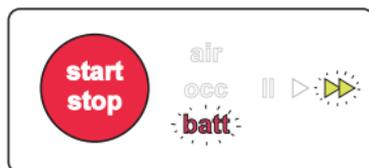
**Problem:** „batt“-Anzeige leuchtet und Gerät signalisiert dauerhaft Alarm.
