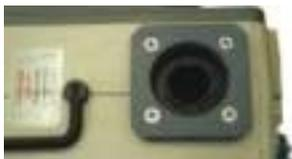
1. Retire los cuatro (4) tornillos de cabeza Phillips de 8-32 x 3 que aseguran el montaje del accesorio de entrada del compresor a la cubierta.
