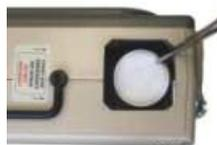
Retire el filtro de disco con una pinza hemostática o unas tenazas, y reemplácelo por un filtro nuevo y limpio. Asegúrese de que el filtro se asiente en posición plana sobre el apoyo en su área empotrada.
