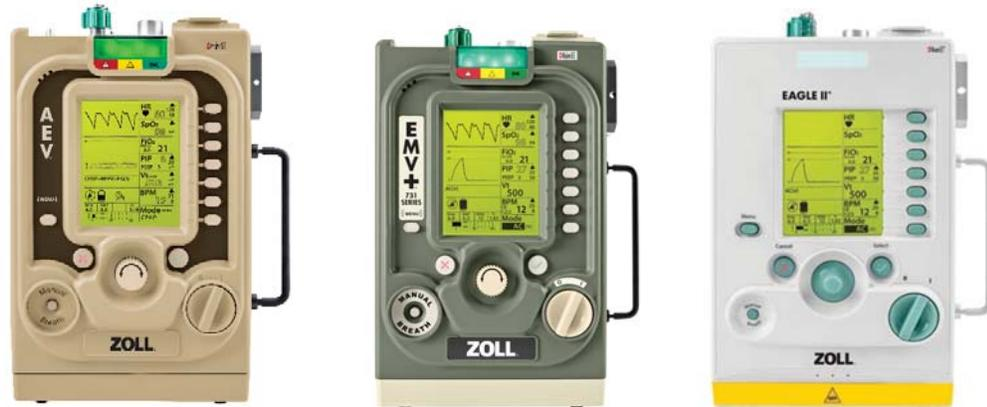
El ventilador AEV está diseñado para tratar pacientes que requieren soporte de ventilador durante el traslado en ambulancia. Sus modos de ventilación (AC, CPAP con soporte de presión y BL) están específicamente desarrollados para ser compatibles con los procedimientos de funcionamiento de los profesionales de atención prehospitalaria.
