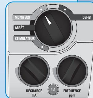
Régages des cadrans pour le monitoring avec l'appareil R Series
