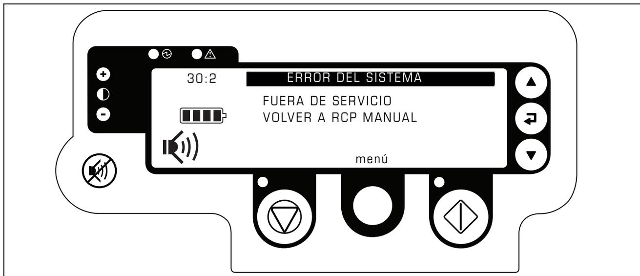
**Figura 5-6** Pantalla de error del sistema
