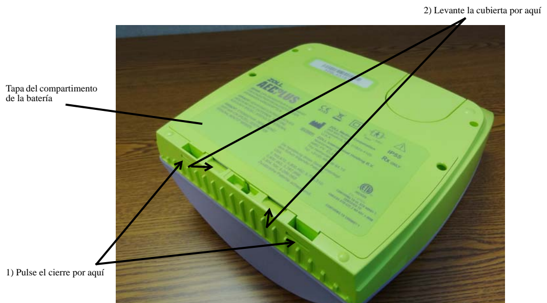
Figura 6: Retirada de la tapa del compartimento de la batería
