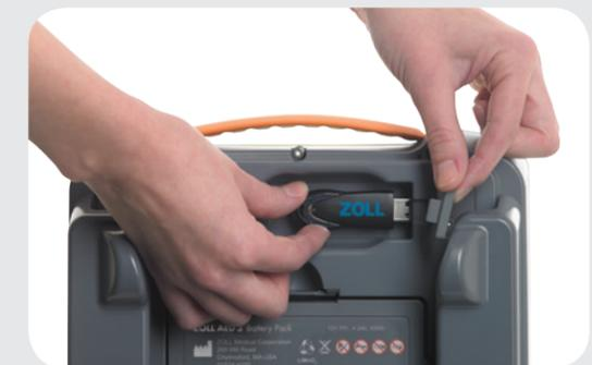
Branchez un clé USB dans le port USB pour télécharger les données d'événements de RCR, charger une nouvelle configuration ou mettre le logiciel à niveau.
