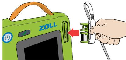
Schließen Sie den Stecker des Defibrillationselektrodenkabels an
