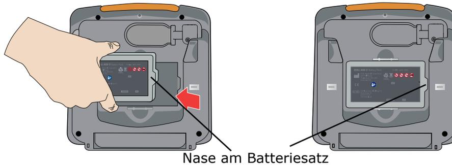
Der AED gibt die Meldung *BATTERIEN ERSETZT* aus und startet automatisch einen Selbsttest.
