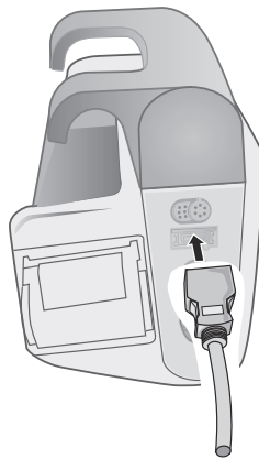
Figur 10-3 Tilslutning af SpO 2 -sensoren til X Series Advanced-enheden
