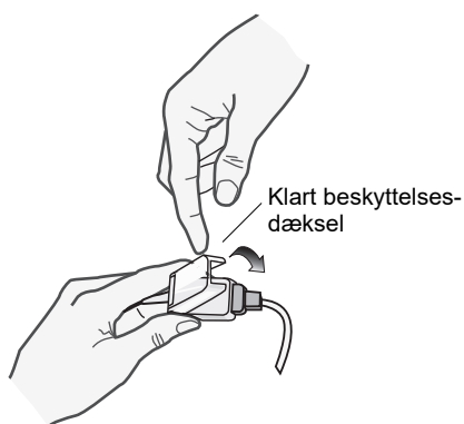
Figur 10-2 Sænkning af plastdækslet ned over kabelkonnektoren
