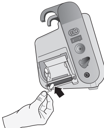
Figur 26-3. Rengøring af printhovedet
