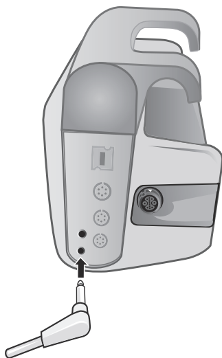
Figur 12-1 Tilslutning af temperatursonden til X Series Advanced-enheden
