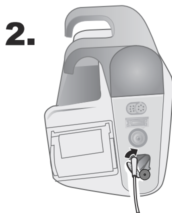
Figur 9-1 Tilslutning af prøvetagningsslangens konnektor til CO 2 -indløbsporten
