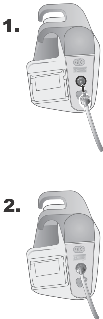
Figur 8-1 Tilslutning af en slange med dobbelt lumen til X Series Advanced-enheden
