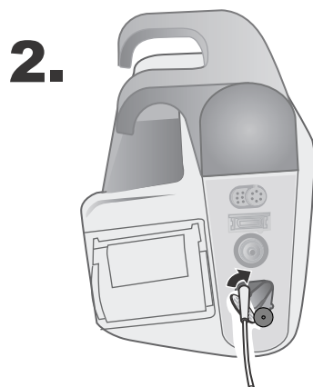
Figur 9-1 Tilslutning af prøvetagningsslangens konnektor til CO 2 -indløbsporten
