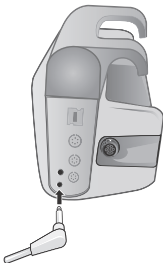
Figur 12-1 Tilslutning af temperatursonden til X Series Advanced-enheden
