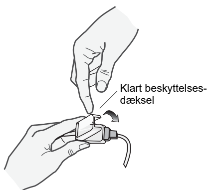
Figur 10-2 Sænkning af plastdækslet ned over kabelkonnektoren
