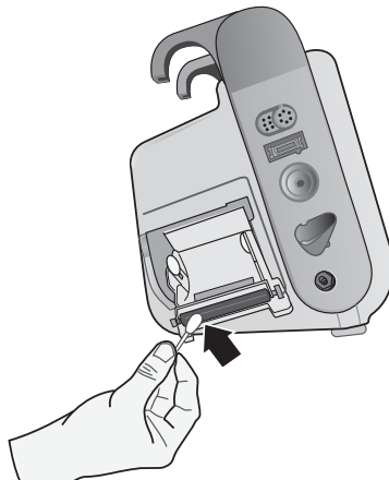
Figur 26-3. Rengøring af printhovedet
