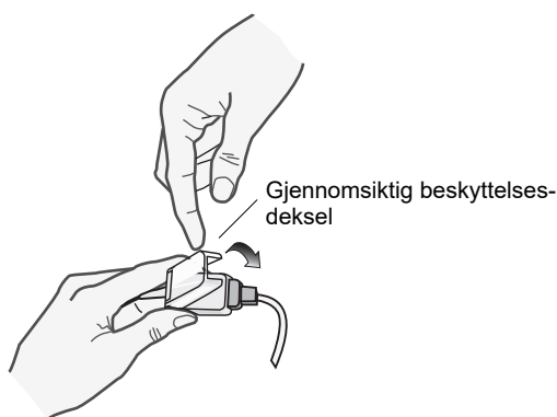
Figur 10-2 Lukk beskyttelsesdekselet i gjennomsiktig plast over tilkoblingen
