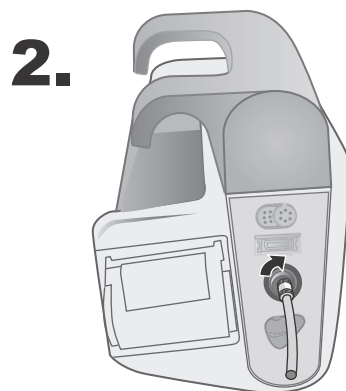
Figur 8-2 Koble en enkeltslange til X Series Advanced-apparatet
