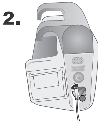
Figur 9-1 Koble prøveslangekoblingen til CO 2 -inngangen
