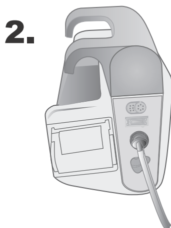
Figur 8-1 Koble en dobbeltslange til X Series Advanced-apparatet
