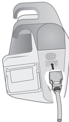
Figur 10-3 Koble SpO 2 -sensorer til X Series Advanced-apparatet
