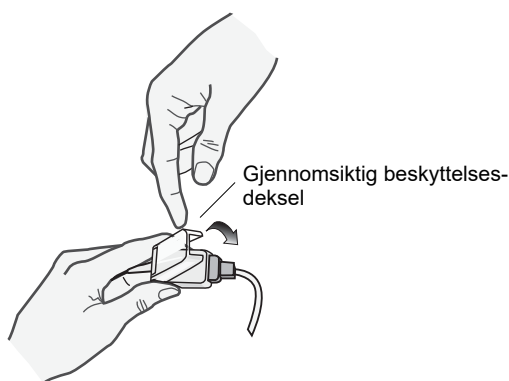
Figur 10-2 Lukk beskyttelsesdekselet i gjennomsiktig plast over tilkoblingen
