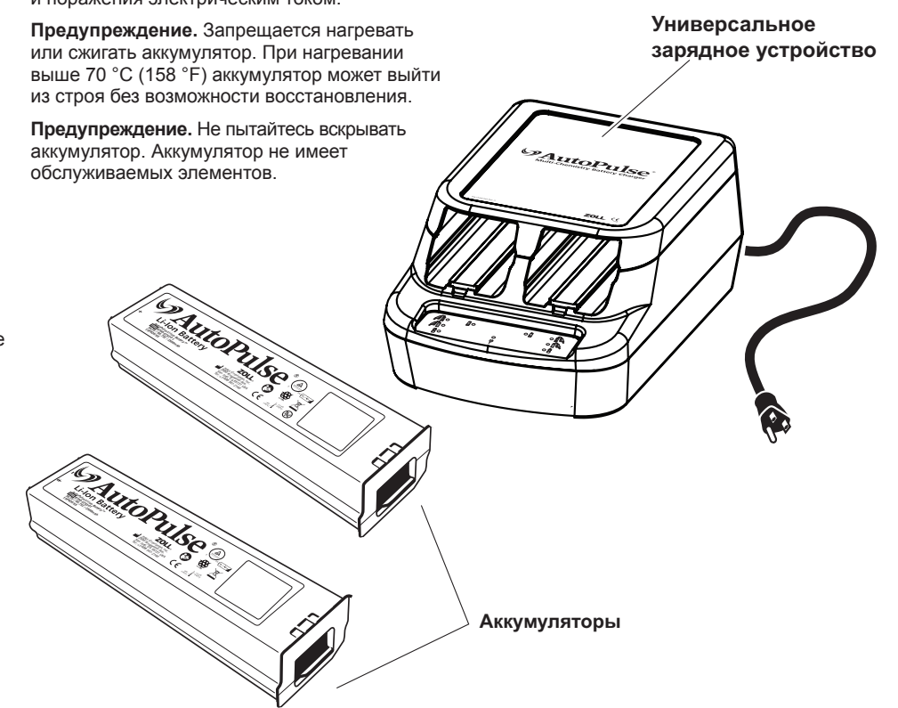
Рис. 1 Компоненты системы питания AutoPulse
