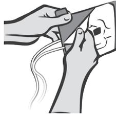
Eine Elektrode in einem festen, gleichmäßigen Zug von der blauen Folie abziehen. Dabei ist es unerheblich, welche Elektrode verwendet wird.
