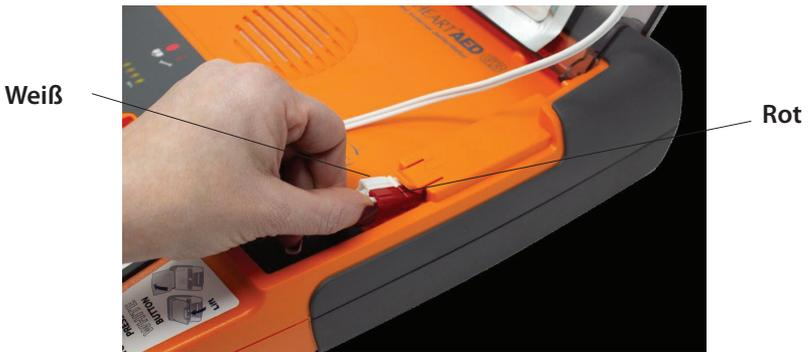
Sobald die Elektroden am AED angeschlossen sind, erlischt die Elektrodenanzeige.
