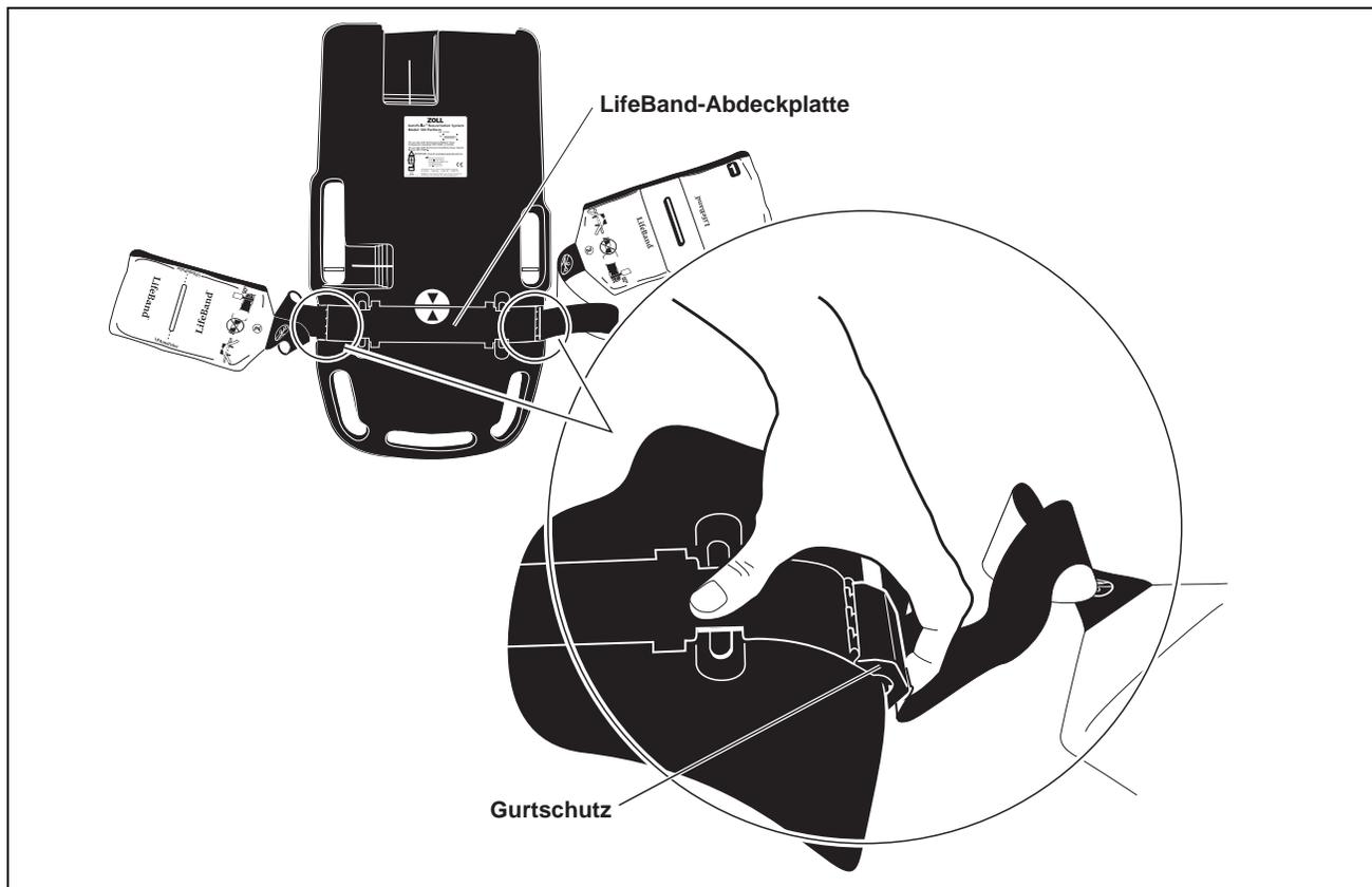
**Abbildung 2-5** Die Gurtschutzklappen des LifeBand nach oben klappen
