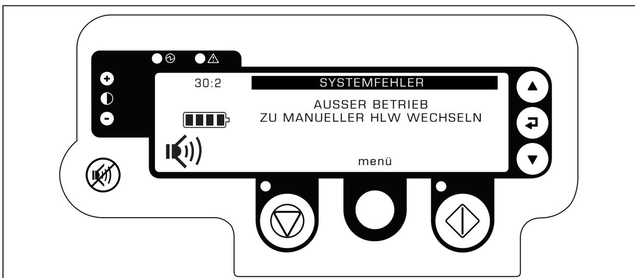
Abbildung 5-6 Display „Systemfehler“
