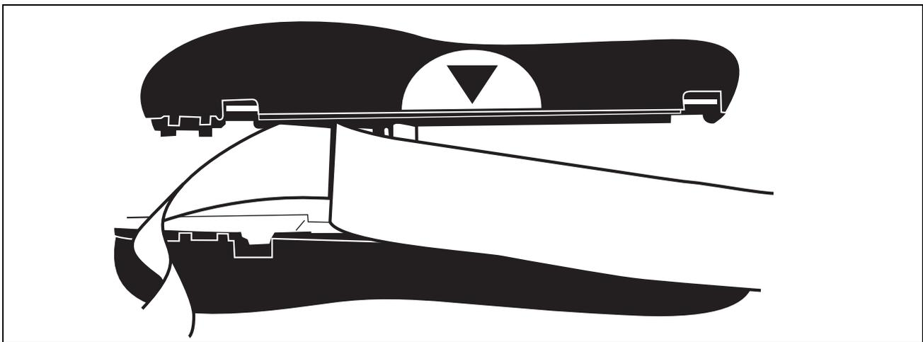
**Abbildung 2-8** *LifeBand NICHT in der Grundposition: Nicht entfernen!*
