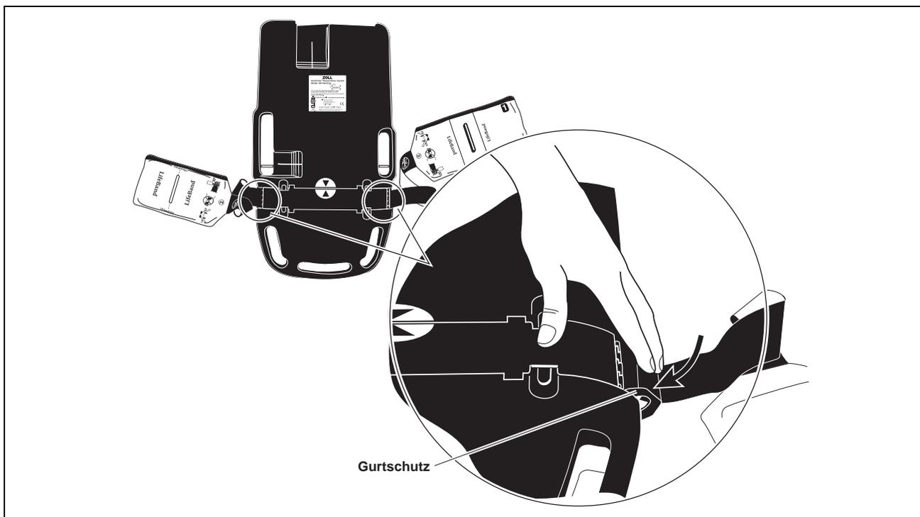
Abbildung 2-4 Die Gurtschutzklappen des LifeBand nach unten klappen
