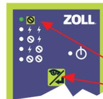
Zeigen Sie mit der Fernsteuerung auf das Gerät, und drücken Sie erneut die **Anzeige/Eingabe**-Taste. An der grünen LED der Fernsteuerung ist zu erkennen, dass der manuelle Szenariomodus ausgewählt ist.
