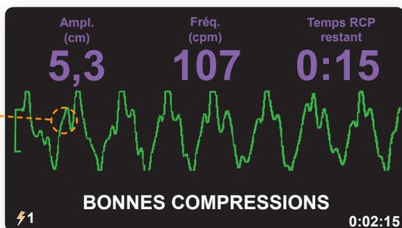
L'AED 3 BLS est facile à configurer pour afficher uniquement le tableau de bord CPR Dashboard™ (image de gauche et première image ci-dessus), ou afficher simultanément ce tableau de bord CPR Dashboard et le tracé ECG (images du milieu et du bas, ci-dessus). Les zones rouges indiquent que le rythme est trop lent et/ou la profondeur est trop faible en mode adulte.
