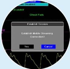
Opzioni di comunicazione: Wi-Fi integrato, Bluetooth® con modem cellulare USB e collegamento Ethernet
